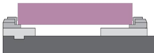
Набор из 4 гладких зажимов с возможностью регулировки по высоте, высота 50 мм.
